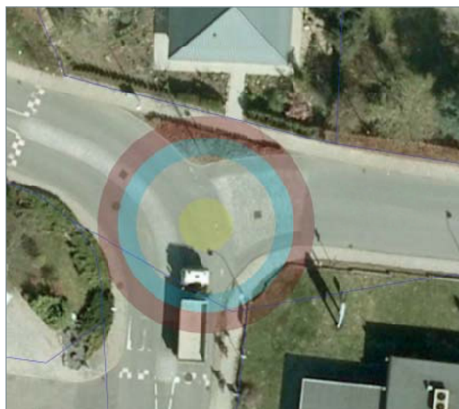
Skitse til minirundkørsel med overkørbar midterø.
